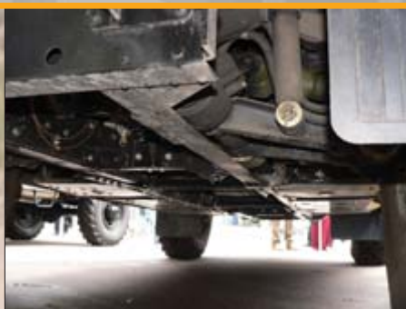
Шасија и детаљи система за ослањање „тигра“ СПМ-2
